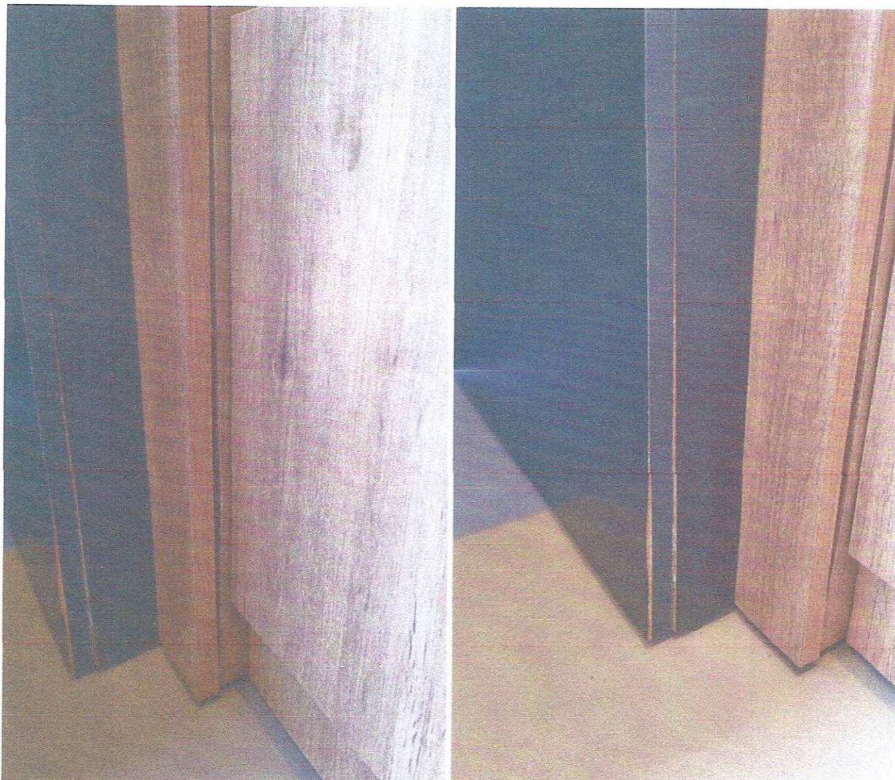
Figura 6 - Estufamento, descolamento, empenamento e presença de mofo na estrutura do móvel.
