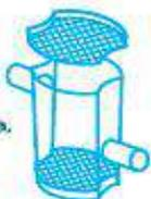
A água usada em lavanderias e banheiros deve ser lançada nas caixas de inspeção. Ela não pode passar pela caixa de gordura.
